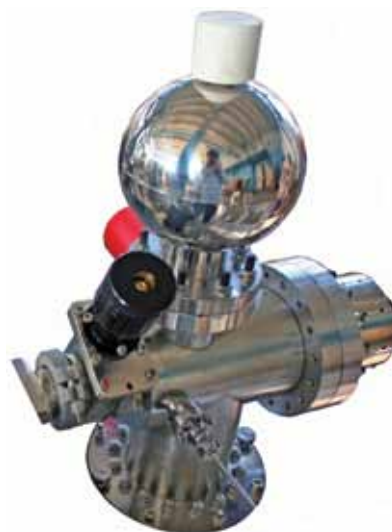
Камера источника ионов для масс-спектрометра
