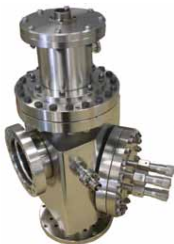
Приемник легких масс для масс-спектрометра
