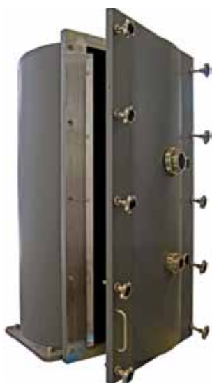
Камера установки роста кристаллов (с объемом до 0.8 м 3 )
