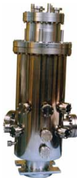
Вакуумный модуль с крио панелью для туннельного микроскопа
