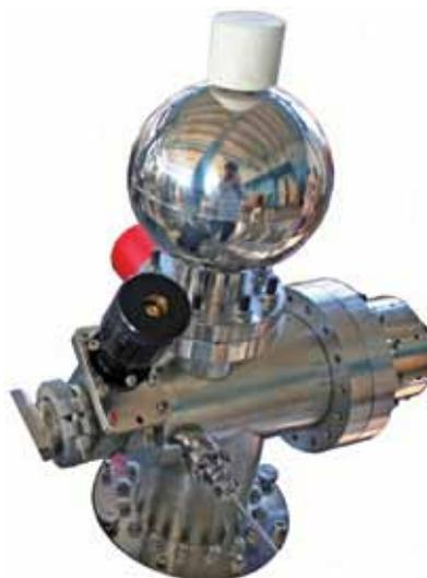
Камера источника ионов
