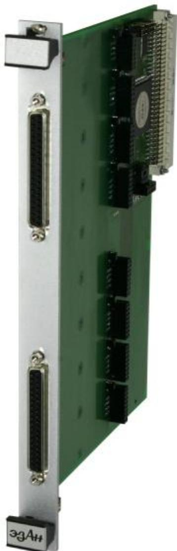
Модуль-носитель 98100/ 98100А предназначен для сопряжения с шиной VME различных устройств, изготовленных в виде плат-мезонинов.
